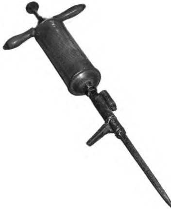
Abb. 6 Injektionsspritze aus der Weinbaugemeinde Maldorf/Kokeltal. Sie diente nach 1890 zur Direktbekämpfung der Reblaus im Weinbergsboden mit flüssigem Schwefelkohlenstoff in der Erstzeit, bis zur Pfropfrebenherstellung ab 1902. (Siebenbürgisches Museum Gundelsheim).
